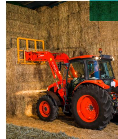
Ya deba trabajar con una horquilla portapalets, una lanza de empacar o un cazo de grano, estos se pueden acoplar y desacoplar rápidamente de la pala frontal LA1854.
