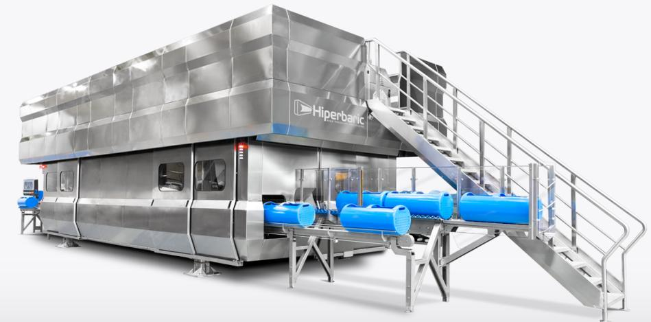
Hiperbaric dispone de **la gama de rendimiento más amplia de máquinas HPP industriales**, que alcanza hasta 6.000 bar / 600 MPa / 87.000 psi, con rendimientos de 700 lb. por hora a 9.000 lb. por hora.
